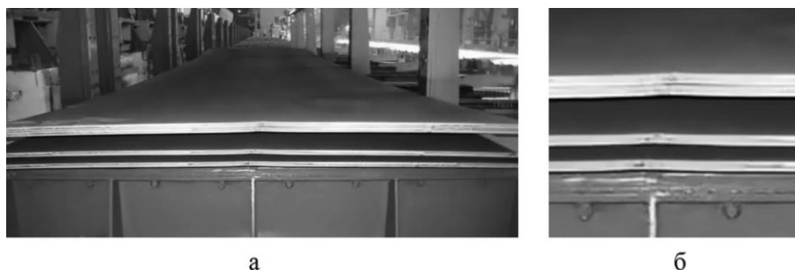
Рис. 1. Вид торцевой поверхности листов, порезанных классическим шевронным ножом: общий (а) и в области смыкания режущих кромок (б)
